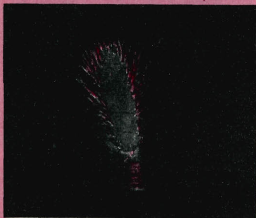
Fig. 3 - Uno degli effetti più strani che si possono verificare sull'elettrodo della bobina di Tesla è quello della formazione di una « spazzola » luminosa.
