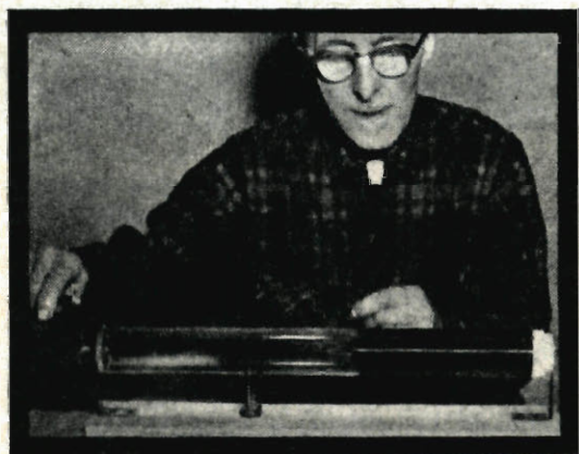
Fig. 9 - Un rudimentale avvolgitore può rendersi molto utile per la realizzazione della bobina L3.
